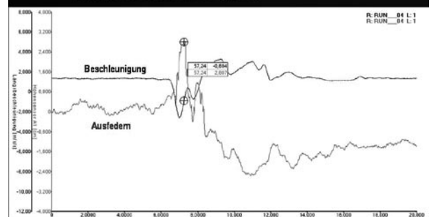
2,8 cm Ausfedern des Hecks bei beschleunigter Rückwärtsfahrt
