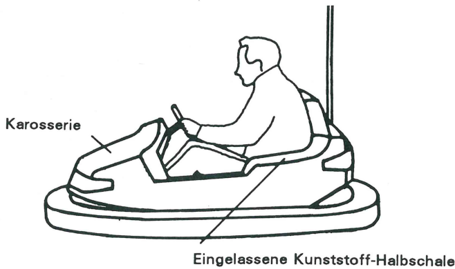
Bild 2 Ergonomisch ungünstige Gestaltung der Rückenlehne im Autoskooter Fig. 2 Ergonomically unfavourable design of the back-rest in a dodgem
