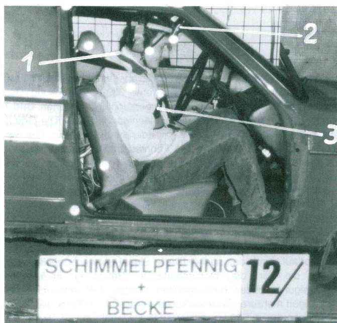
Bild 10 Mit Markern versehener Proband 1 EMG-Elektroden 2 Kopfbeschleunigungssensor 3 Brustbeschleunigungssensor. Fig. 10 Proband equipped with markers
