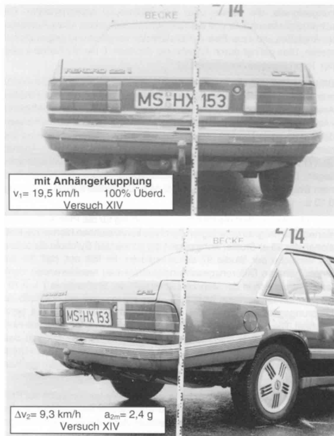
Bild 14 Beschädigungsbilder der Versuchsfahrzeuge mit und ohne Anhängerkupplung
