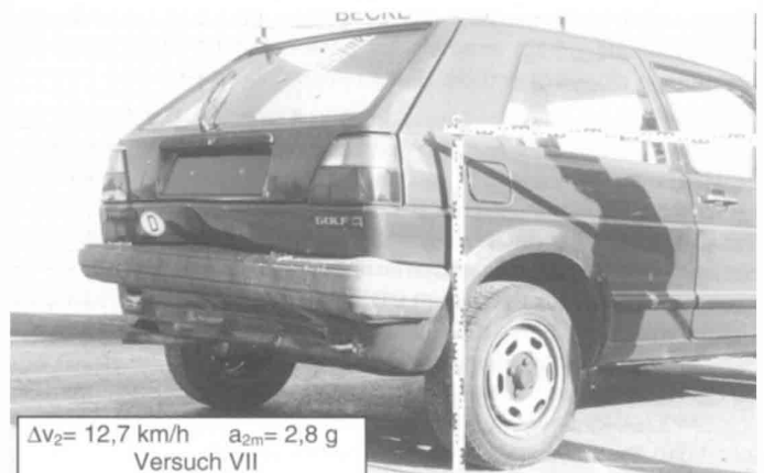
Bild 12 Beschädigungsbilder der Versuchsfahrzeuge («Stoßfänger-auf-Stoßfänger-Anprall») Fig. 12 Vehicle damages («bumper to bumper impact»)
