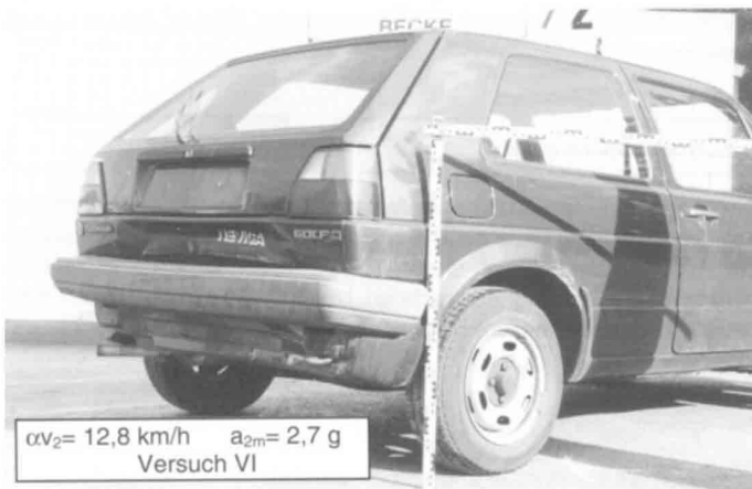
Bild 10 Vergleich der Beschädigungsbilder der Versuchsfahrzeuge bei unterschiedlichen Überdeckungsgraden
