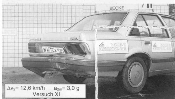
Bild 13 Beschädigungsbilder unterschiedlicher Fahrzeugkonzepte Fig. 13 Vehicle damages of different car conceptions
