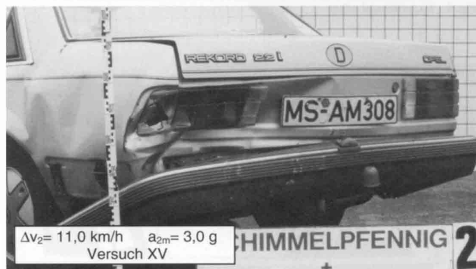
Bild 6 Beschädigungsbilder Versuchsfahrzeuge ( v_1 = 25 \text{ km/h} , \Delta v_2 = 11 \text{ km/h} ) Fig. 6 Damages of crash test vehicles ( v_1 = 25 \text{ km/h} , \Delta v_2 = 11 \text{ km/h} )
