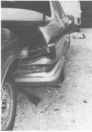
Bild 6 Sekundärverformungen an der rechten hinteren Ecke eines DB außerhalb des Kontaktbereiches
